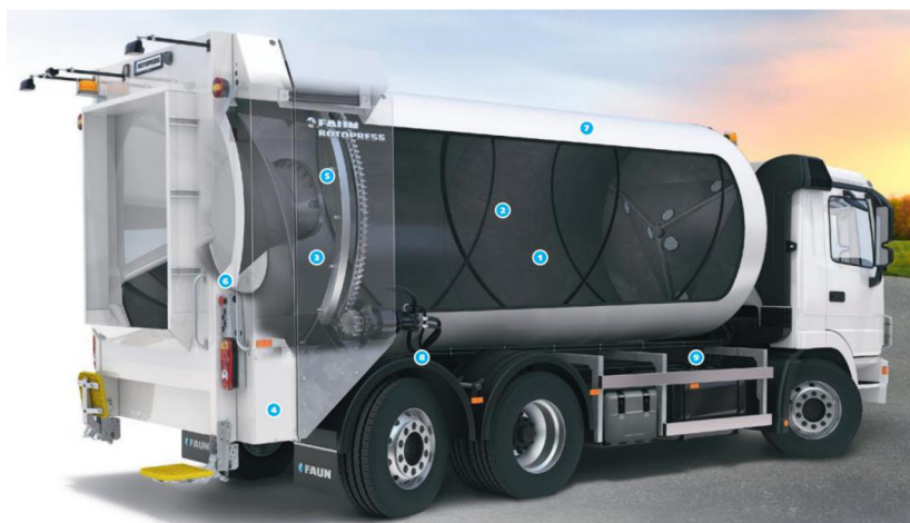
Obrázek 18 Schéma rotačního mechanismu u svozových automobilů
