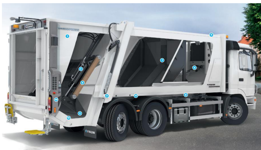
Obrázek 19 Schéma lineárního mechanismu u svozových automobilů
