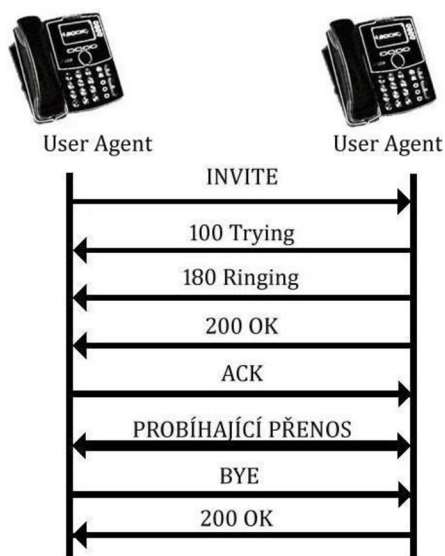
Obr. 2.1: Příklad možné komunikace mezi dvěma UA zařízeními
