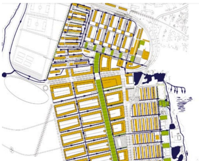
Obrázek 12 Výřez plánu nakládání s dešťovou vodou v Scharnhauser Parku (Bavorský zemský úřad, 2006)
