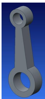
Obr. 6.1 Zjednodušený model ojnice
