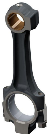
Obr. 5.3 Ojnice řešeného mechanismu
