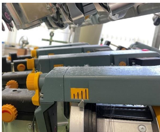
Obr. 11a. Krátká vlákna na odvíječi útkových niti
