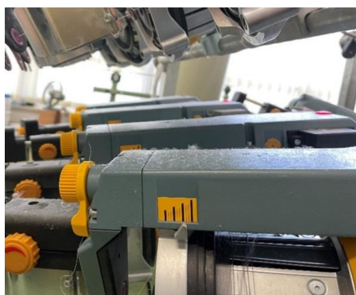
Obr. 11a. Krátká vlákna na odvíječi útkových niti
