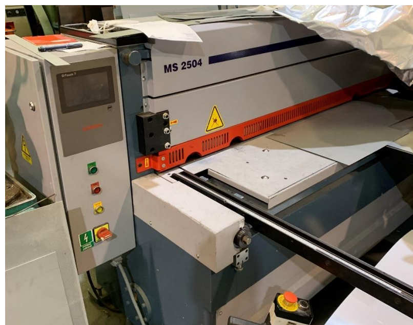
Obr. 27 Stroj pro stříhání
