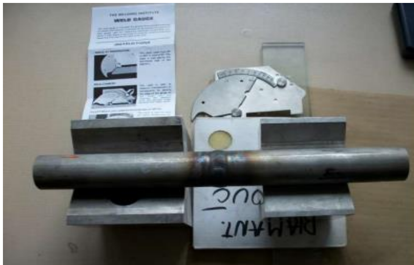
Obr. 18 Kontrola svaru pomocí vizuální zkoušky. [31]
