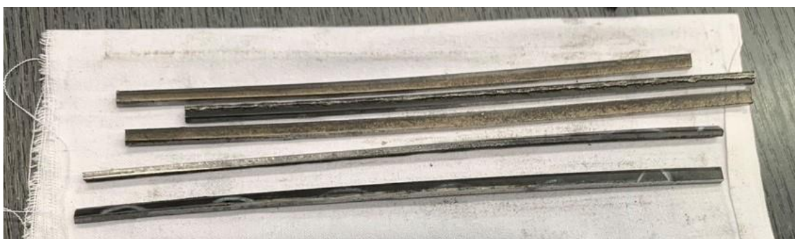
Obr. 29 Zkušební vzorky pro TOO, TOO + Svar, Svar
