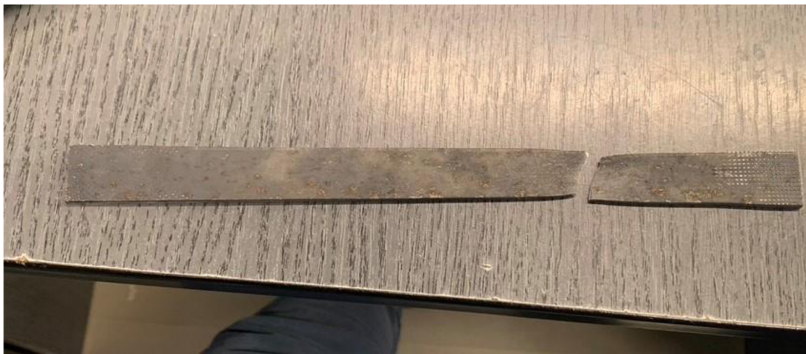
Obr. 32 Roztržený zkušební vzorek
