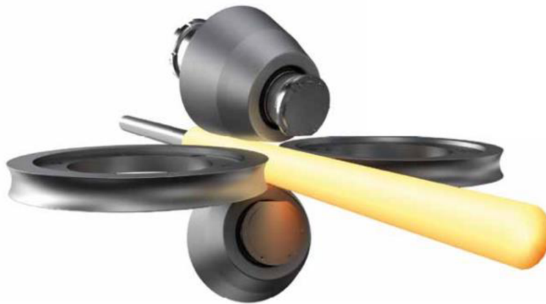
Obr. 10 Diescherův způsob výroby trubek. [18]
