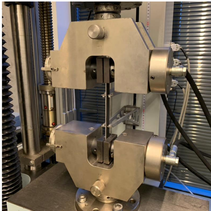
Obr. 28 Stroj pro zkoušku tahem
