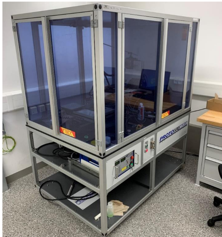
Obr. 57 Stroj pro měření zbytkových napětí Proto iXRD COMBO
