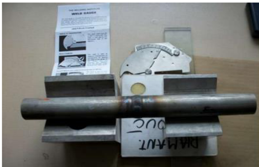
Obr. 18 Kontrola svaru pomocí vizuální zkoušky. [31]
