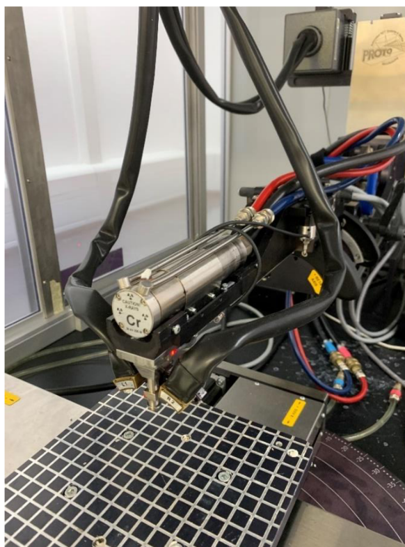
Obr. 58 Pohled na pracovní stůl stroje + Cr rentgenku
