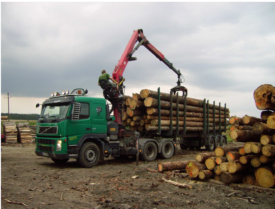
Obr. 16 Technologie odvozu dříví odvozní soupravou s HR (foto autor)
