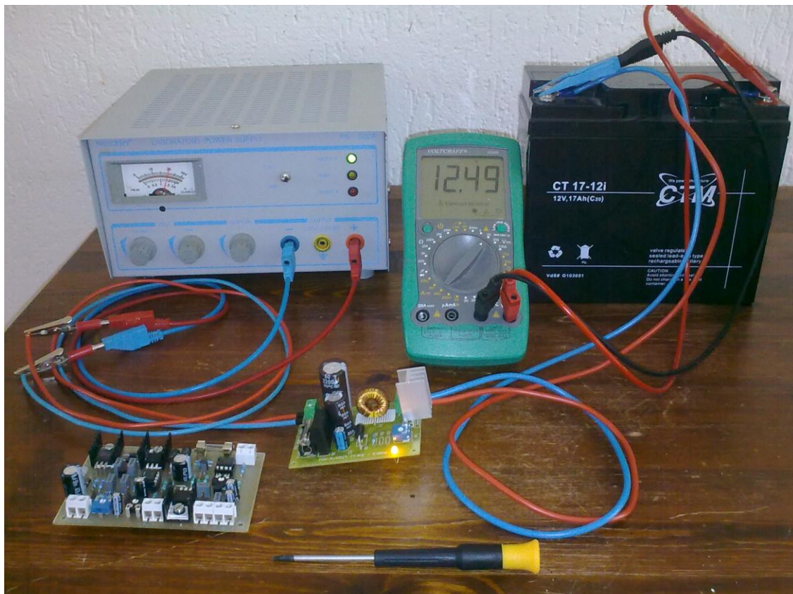
Obrázek 18.: Testování FV regulátorů při nabíjení olověného akumulátoru
