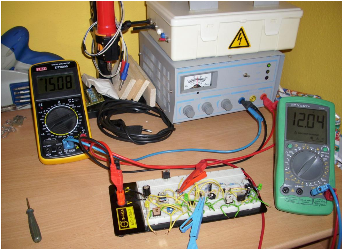
Obrázek 16.: Testování FV regulátoru s obvodem LM317 na kontaktním nepájivém poli
