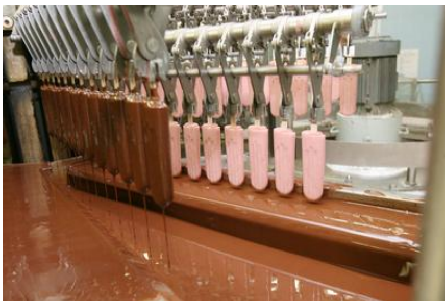
Obrázek 8. Proces obalování nanuků do čokolády. Zdroj: www.ahaonline.cz
