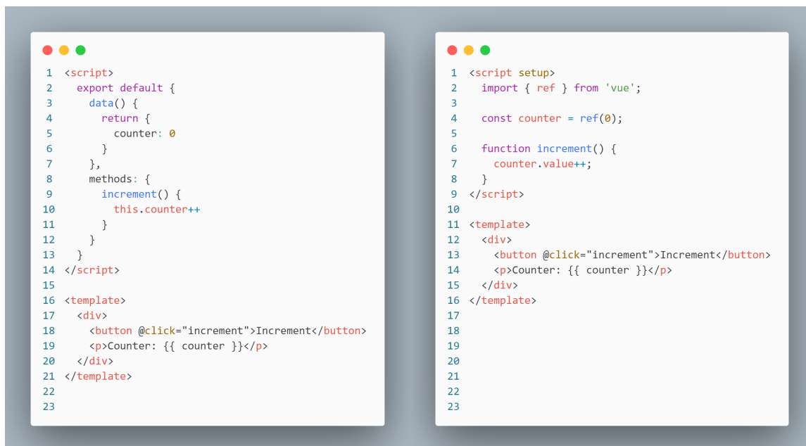
Obrázek 5.7: Rozdíl mezi komponentou naprogramovanou v Options API (vlevo) a Composition API (vpravo)
