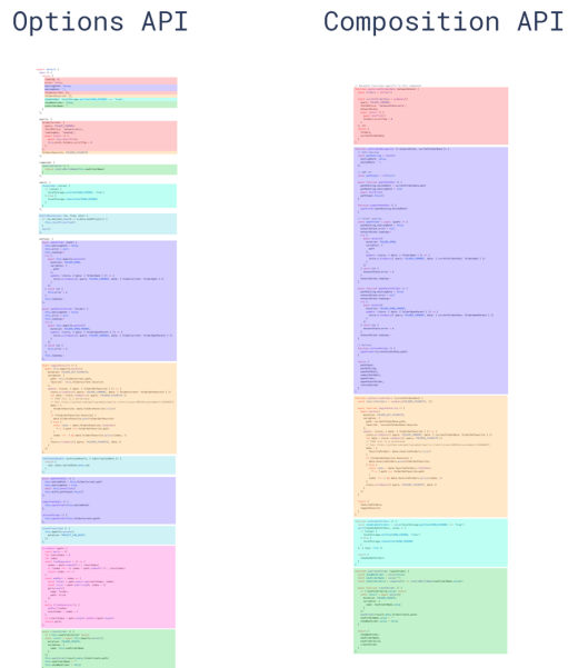
Obrázek 5.8: Na obrázku je vidět, jak může být kód roztroušen do různých částí zdrojového souboru. Podbarvené sekce stejnou barvou se týkají jedné funkcionality a jak lze vidět, v Options API je kód v různých částech souboru, kdežto v Composition API je vše, co se týká jedné funkcionality na jednom místě. Obrázek je převzat z [76].
