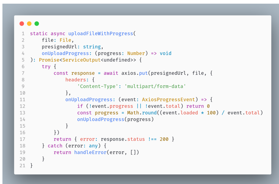
Obrázek 6.9: Zdrojový kód metody, která nahrává soubor na zadanou url adresu. Při nahrávání souboru lze specifikovat funkci onUploadProgress v parametru metody, která informuje o celkovém průběhu nahrávání v procentech. Díky této funkci lze aktualizovat stav nahrávání ve stavové proměnné a tím pádem i v uživatelském rozhraní.
