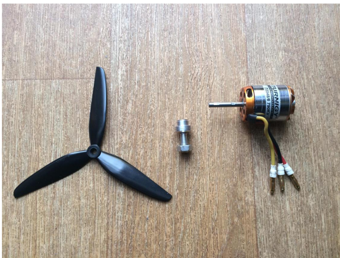
Obrázek 19. Druhá konfigurace, BLDC motor s třílistou vrtulí
