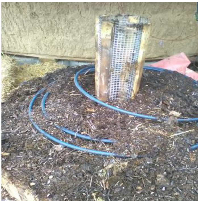
Obrázek 4-8 Umístění polyetylenové hadice do bioreaktoru
