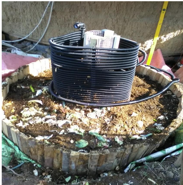
Obrázek 4-6 Umístění výměníku do bioreaktoru
