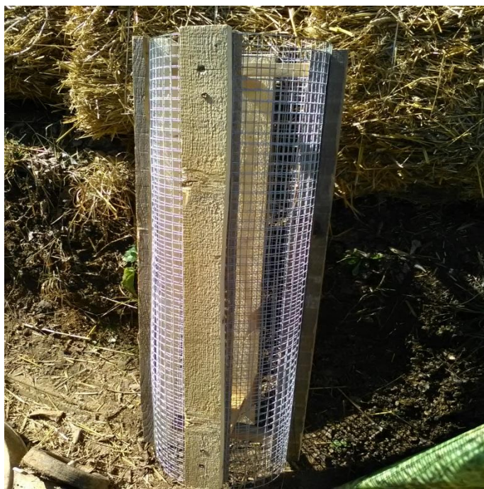
Obrázek 4-7 Konstrukce k jímání bioplynu
