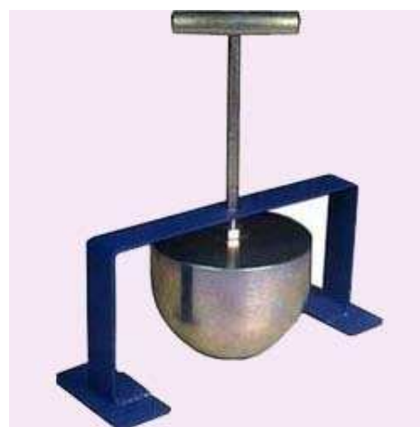
Obr. 3-2 Kelly ball test – přístroj [13]
