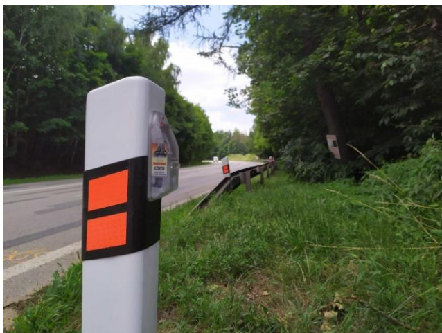
Obrázek 4: Elektronický plašič DeerDeter (Ředitelství silnic a dálnic, ©2022)
