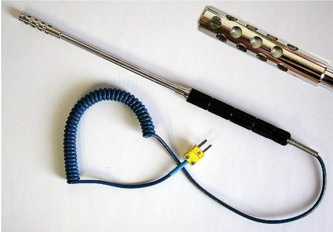
Obr.7: Termočláňkový teplotní senzor uzpůsobený pro měření teploty vzduchu [6]
