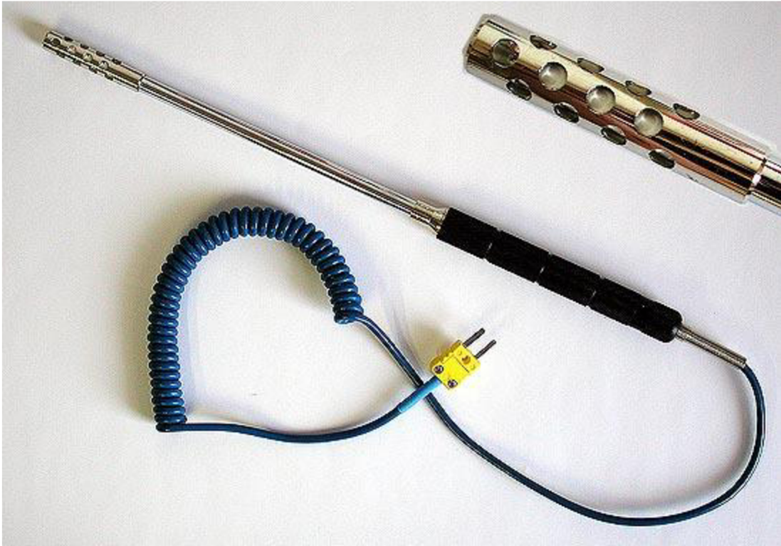
Obr.7: Termočlánkový teplotní senzor uzpůsobený pro měření teploty vzduchu [6]
