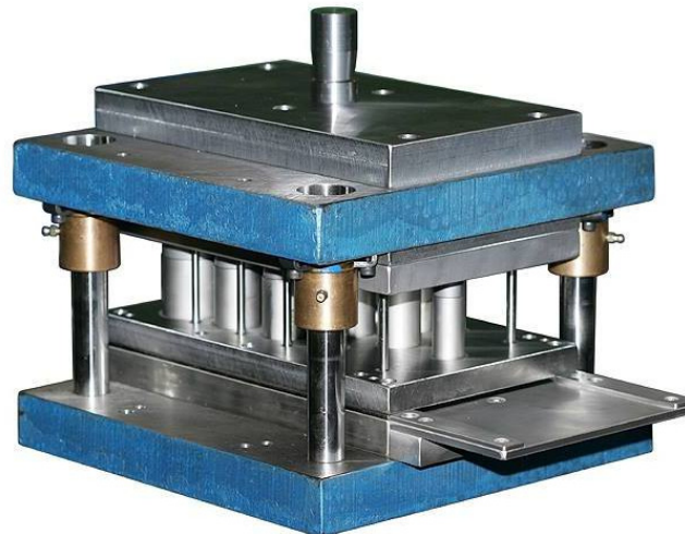
Obr. 8.11 Střížný nástroj s vodícími sloupky
