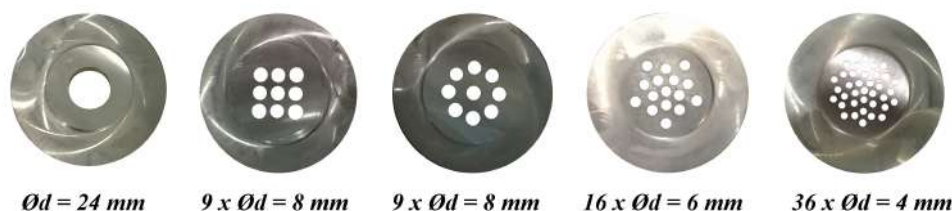
Obr. 1.20: Kavitačné clony s rôznym počtom otvorov spĺňajú podmienku konštantnej prietocnej plochy (upravené) [22]
