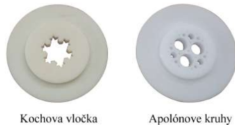
Obr. 1.25: Kavitačné clony vytvorené pomocou fraktálnej geometrie s dodržaním podmienky konštantnej svetlosti s clonami z práce [22] (upravené), zdroj: [16]
