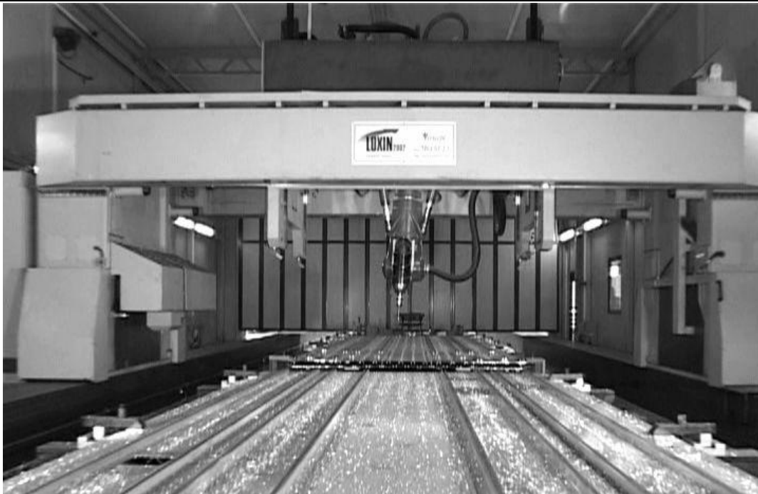
Obr. 31: Tricept T805 jako frézka [9]
