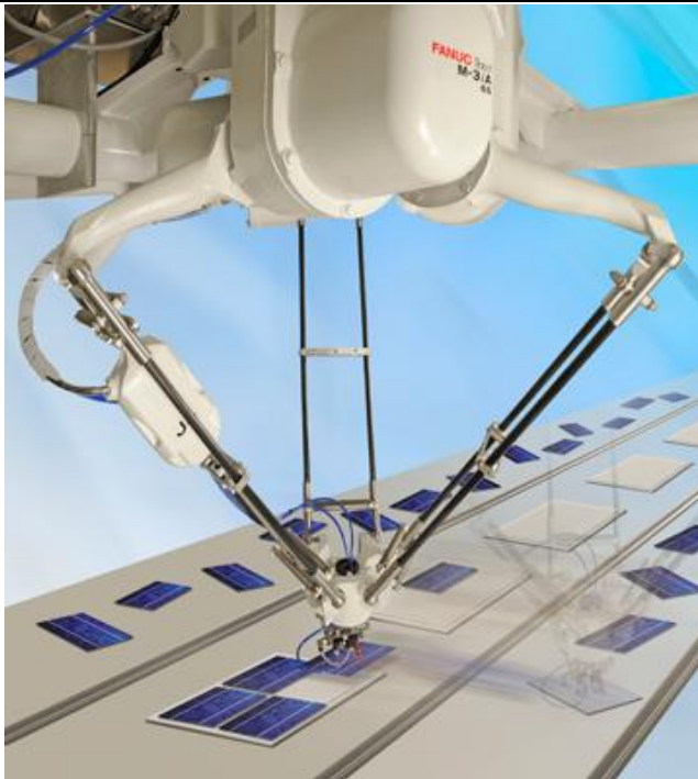
Obr. 37: M-3iA se čtyřmi stupni volnosti manipuluje, orientuje a sestavuje objekty [2]
