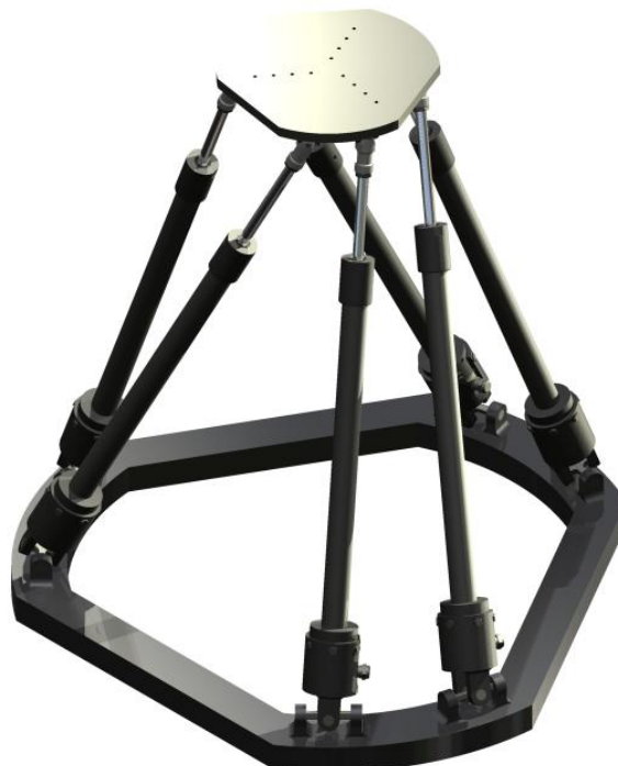
Obr. 73: Výsledný návrh hexapodu s nově navrženými pohony
