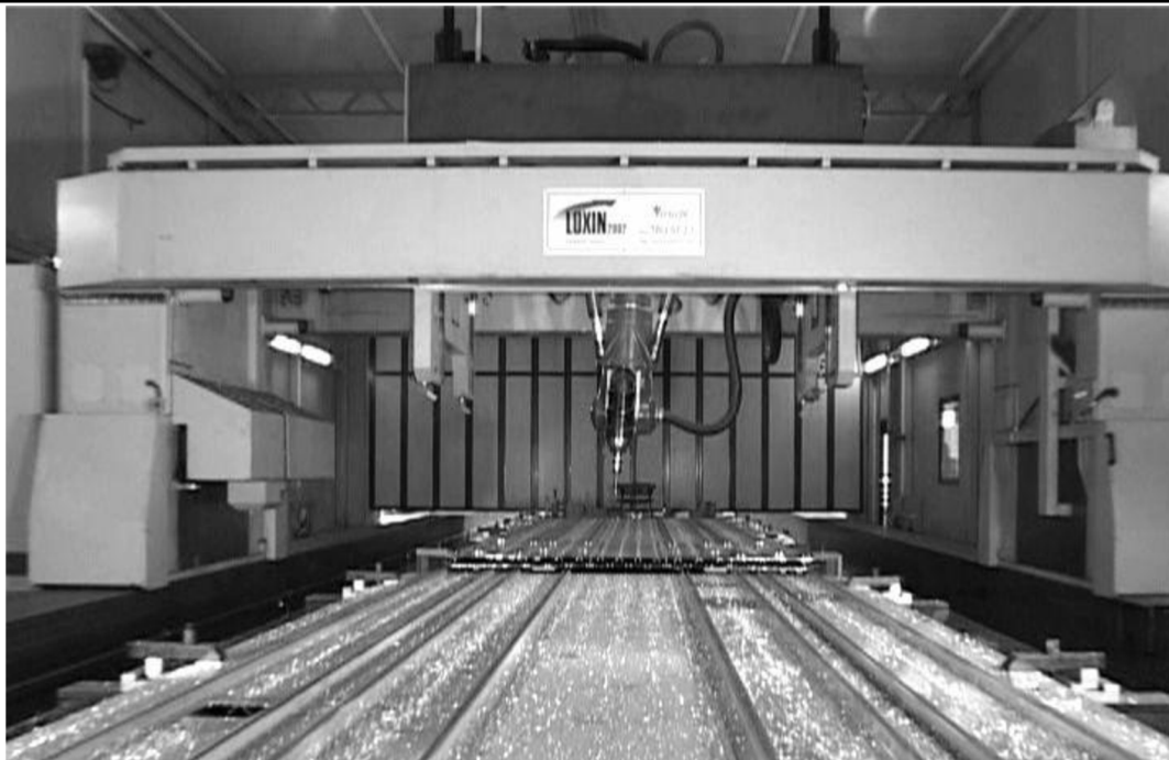
Obr. 31: Tricept T805 jako frézka [9]
