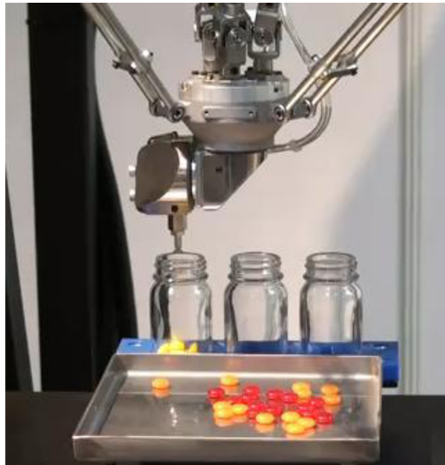
Obr. 35: Detail ramene robotu při balení různobarevných bonbónů [2]
