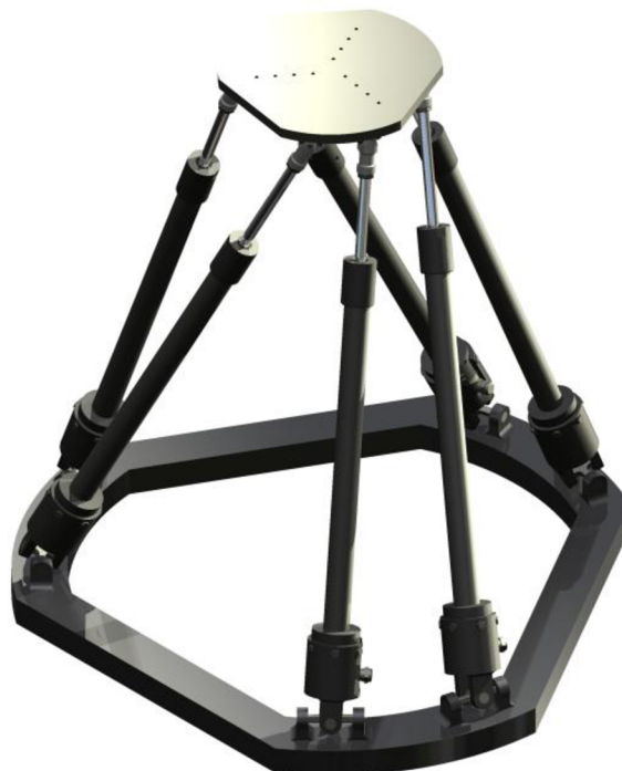
Obr. 73: Výsledný návrh hexapodu s nově navrženými pohony
