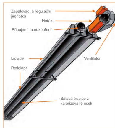
Obrázek 16. Tmavý plynový zářič [23]
