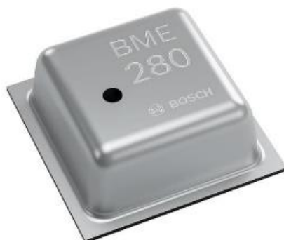
Obrázek 29 – Snímač vlhkosti BME280 [37]
