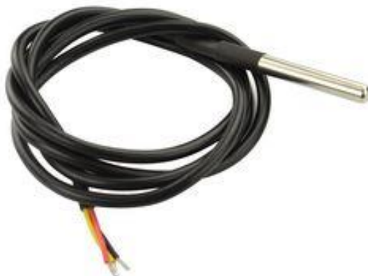
Obrázek 28 – Teplotní čidlo DS18B20 [36]
