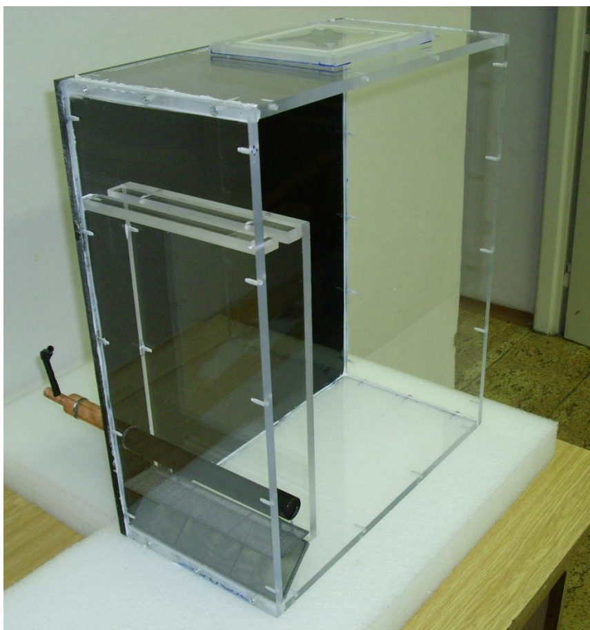
Obrázek 23: Experimentální zařízení pro studii součinitele přestupu tepla na povrchu horizontálního válce. Materiál, tvrzený PMMA, byl vybrán pro ověření výsledků pomocí PIV a LIF [46].
