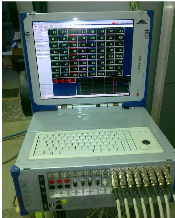
Obrázek 11: Měřicí systém DEWE 5000 firmy Dewetron s 64 termočlánekovými sloty, sloužil jako hlavní záznamové zařízení.
