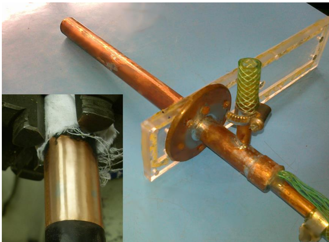
Obrázek 22: Trubka průměru 22 mm se zabudovanými deseti termočláneky po obvodu ve středové části a detailní pohled na zabroušenou část.
