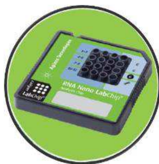
Obrázek 12. Čipy používané v Agilent 2100 Bioanalyser, na obrázku RNA Nano LabChip (převzato z www.biomedicalgenomics.org )
