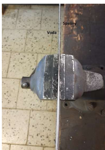
Obrázek 16 nerovnoměrný úbytek materiálu (vlastní zdroj)
