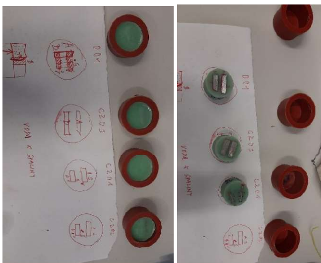
Obrázek 14 zalití vzorků do pryskyřice (vlastní zdroj)
