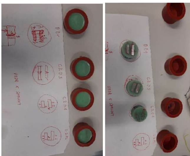
Obrázek 14 zalití vzorků do pryskyřice (vlastní zdroj)
