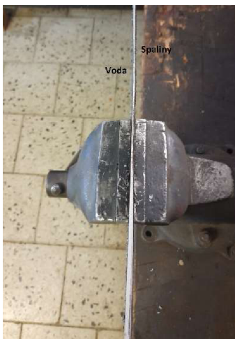
Obrázek 16 nerovnoměrný úbytek materiálu (vlastní zdroj)
