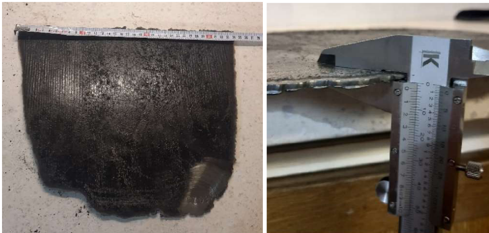
Obrázek 11 vzorek CZ01 po vyříznutí z kotle a úbytek materiálu (vlastní zdroj)
