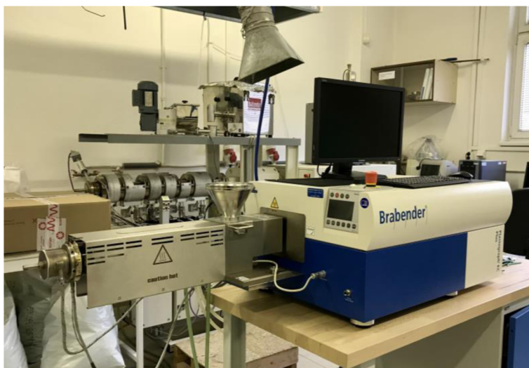
Obr. 20 Plastograph EC Plus s jednošnekovým extrudérem 19/25 D (Brabender GmbH)
