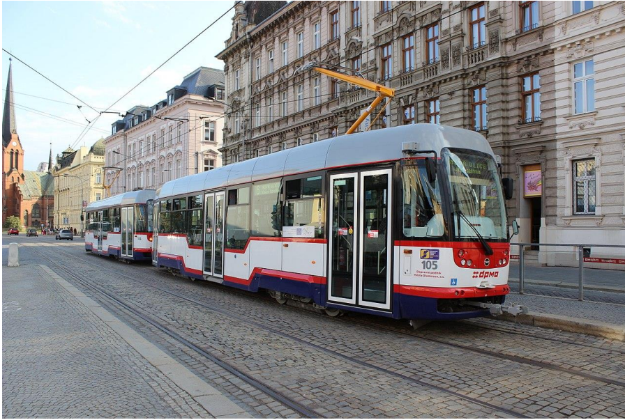
Obr. 12: Tramvaj VariolF plus/o s oboustranným dveřním systémem.
