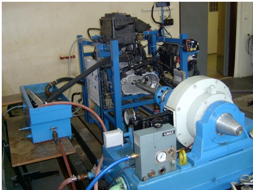
Obr. 9: Brzdové stanoviště (motor + vířivý dynamometr)
