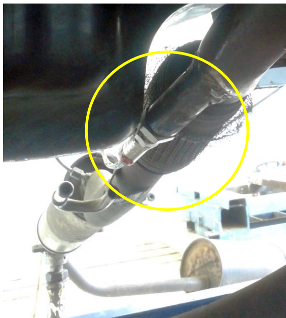
Obr. 7: Umístění teplotního čidla
