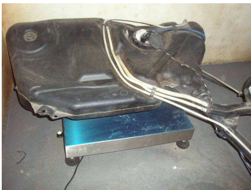
Obr. 16: Umístění nádrže na vážicím zařízení
