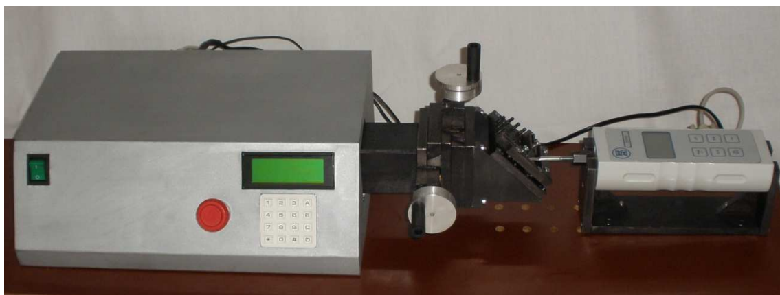
Obr. 5.7: Uspořádání pro testování vývodů pouzder integrovaných obvodů
