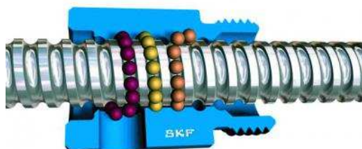
Obr. 2.6: Řez kuličkovou maticí [6]
