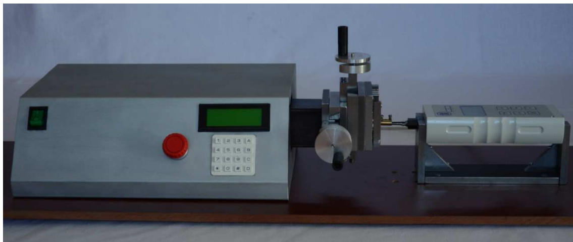
Obr. 5.6: Uspořádání pro testování vývodů pouzder BGA
