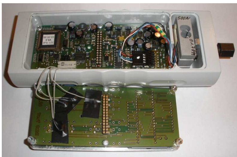
Obr. 3.17: Vnitřní uspořádání měřidla TEST 321
