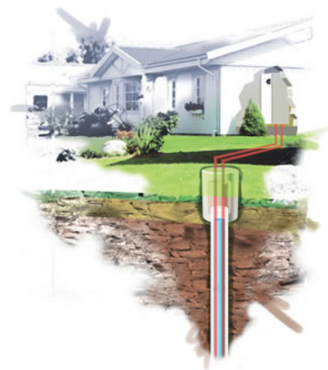
Obr.3 – Tepelné čerpadlo s vrty, Zdroj: [14]
