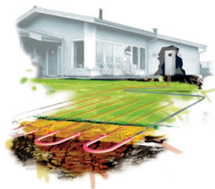
Obr.4 – Tepelné čerpadlo s plošným kolektorem, Zdroj: [14]
