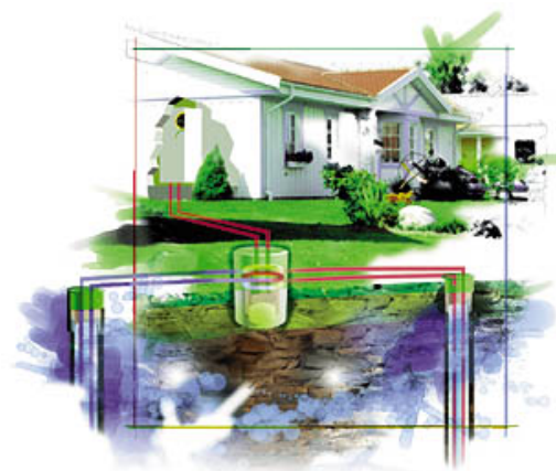
Obr.2 – Tepelné čerpadlo voda–voda, Zdroj: [14]
