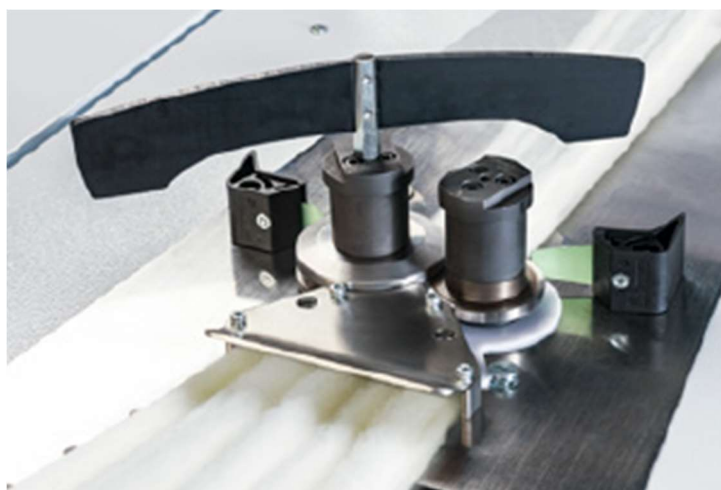
Obr. 16 – Sensor měřící množství hmoty v předkládaných pramenech [10]
