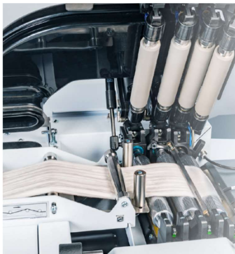
Obr. 17 – Průtahové ústrojí stroje Trützschler TD10[10]
