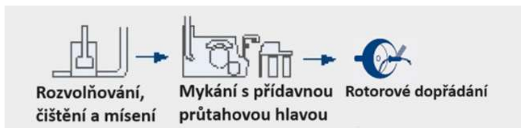
Obr. 12 - Nákres technologického plánu s použitím IDF pro rotorové předání [7]
