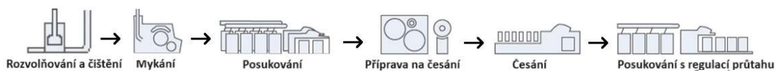
Obr. 21 – Grafické znázornění strojového vybavení pro standardní proces přípravy pramene pro bavlněné vlákna [7]
