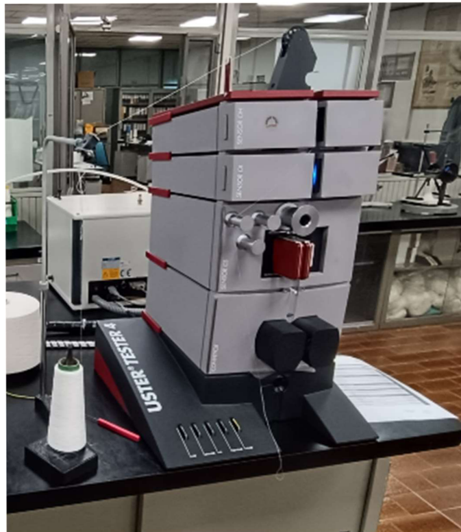
Obr. 25 – Uster Tester 4 v laboratoři Savio
