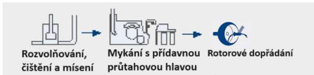
Obr. 12 - Nákres technologického plánu s použitím IDF pro rotorové předění [7]
