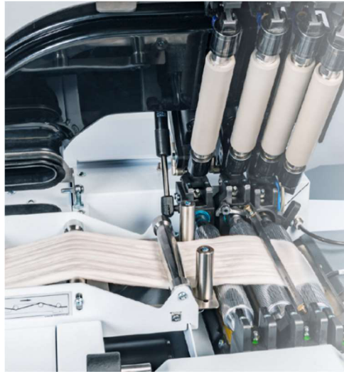
Obr. 17 – Průtahové ústrojí stroje Trützschler TD10[10]
