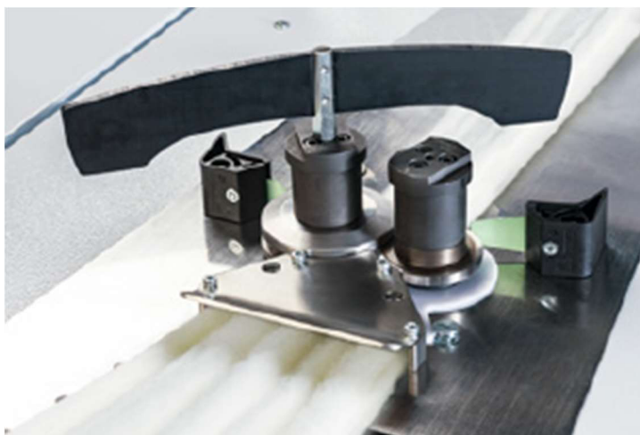
Obr. 16 – Sensor měřící množství hmoty v předkládaných pramenech [10]
