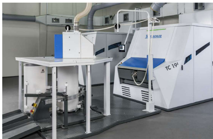
Obr. 13 – Mykací stroj TC19i od firmy Trützschler s IDF [12]
