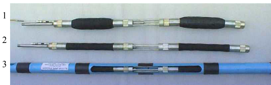
Obr.:4.2.1 – Pohled na obturátor (1- nafouknuté těsnění, 2 – těsnění v klidu, 3 – obturátor v injektážní trubici v x-té etáži)
