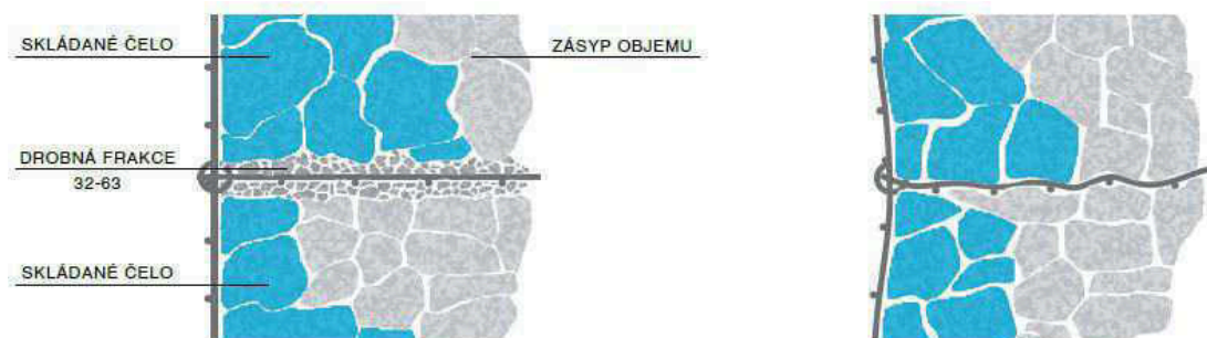
Obr.:3.2.4.10 - Vysypání drobným kamenivem horní síť gabionu
