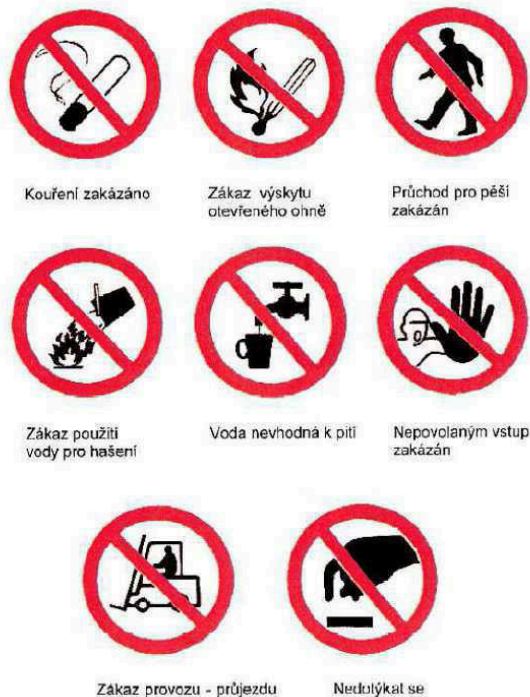
Obr.:2.3.1.1 Zákazové vnitrostaveništní značky
