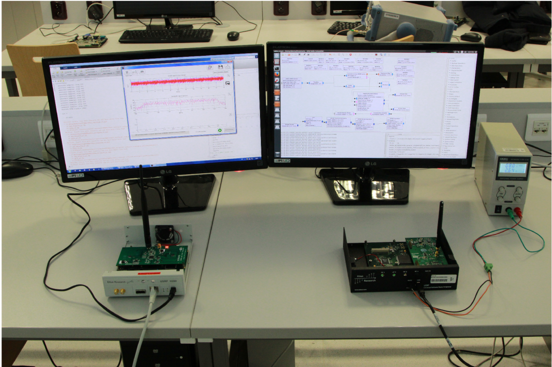
Obr. 2.16: Bezdrôtové vysielanie dát pomocou vytvoreného programu na demonštráciu OFDM
