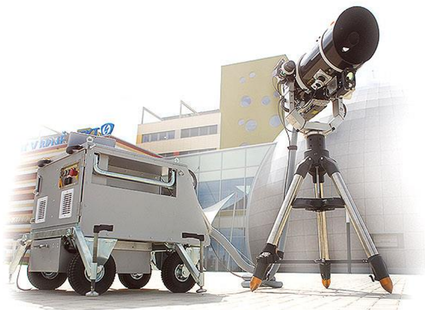
Obrázek 8: rLIBS mobilní laboratoř LIBS od CEITEC VUT – počítačem řízené modulární zařízení schopné provádět analýzu na dálku (vzdálenost i více jak 20 m). [26]
