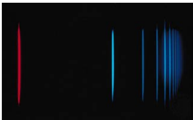
Obrázek 2: Balmerova řada vodíku zobrazena spektrometrem s nízkým rozlišením. [1]
