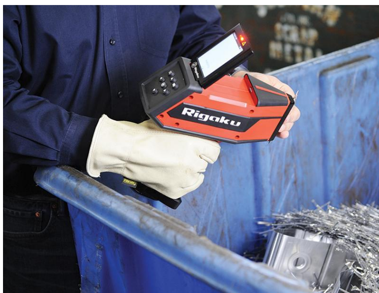
Obrázek 9: Příruční LIBS analyzátor kovů a slitin RIGAKU KT-100S. [27]
