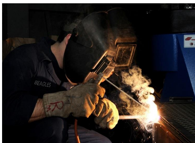
Obr. 2 Svařování elektrickým obloukem s obalenou elektrodou [15]
