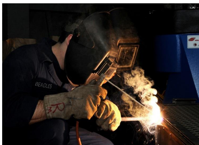
Obr. 2 Svařování elektrickým obloukem s obalenou elektrodou [15]
