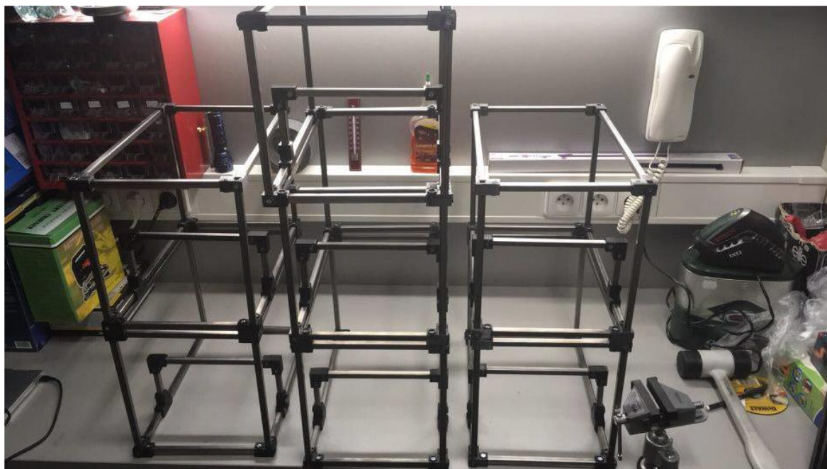
Obrázek 10 - Ukázka modulární ocelové konstrukce rigu, vlastní zpracování
