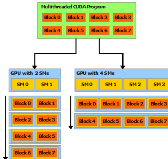
Obr. 2.1: Automatické rozdelenie úloh medzi multiprocessory (SM).[2]
