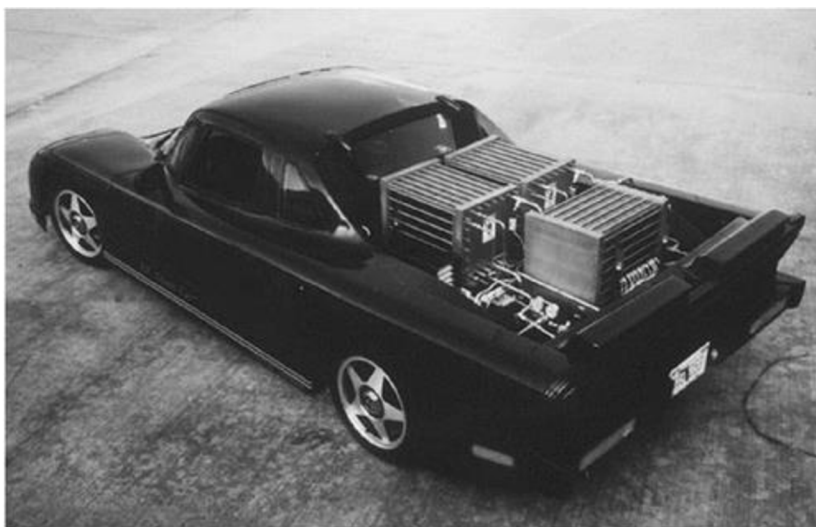
Obr.2.2 První osobní automobil s PEM palivovým článkem z roku 1993 [22]
