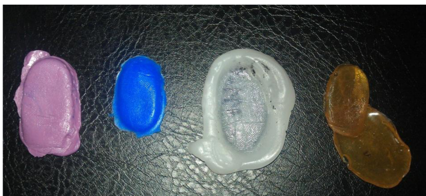
Obrázek 4.2: Obrázek několika umělých prstů z různých materiálů (latex, durocast, vosk) různého zabarvení. Po radě očíslované zleva jako vzorek 1 - 4.
