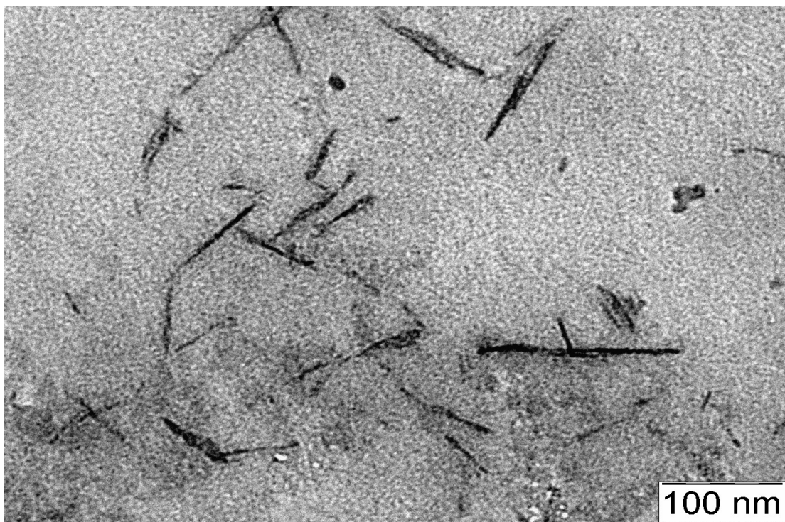
Obr. č. 8: TEM snímek částic mědi stabilizovaných želatinou po redukcii tetrahydridoboritanem sodným při koncentraci \text{CuSO}_4 0,002 \text{ mol.l}^{-1} .
