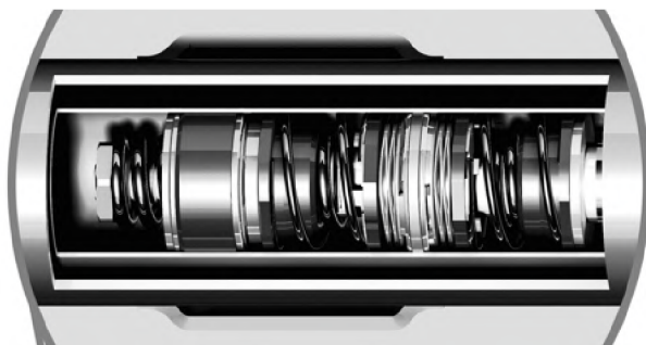
Obr. 2.8: ZF Sachs SDC tlumič s plovoucím pístem [6].
