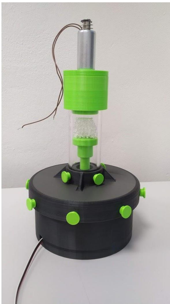
Obr. 16) Zatěžovací zařízení se vzorkem v zatěžovací komoře
