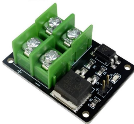
Obr. 10) PWM MOSFET MODUL F5305 55VDC 31A [11]
