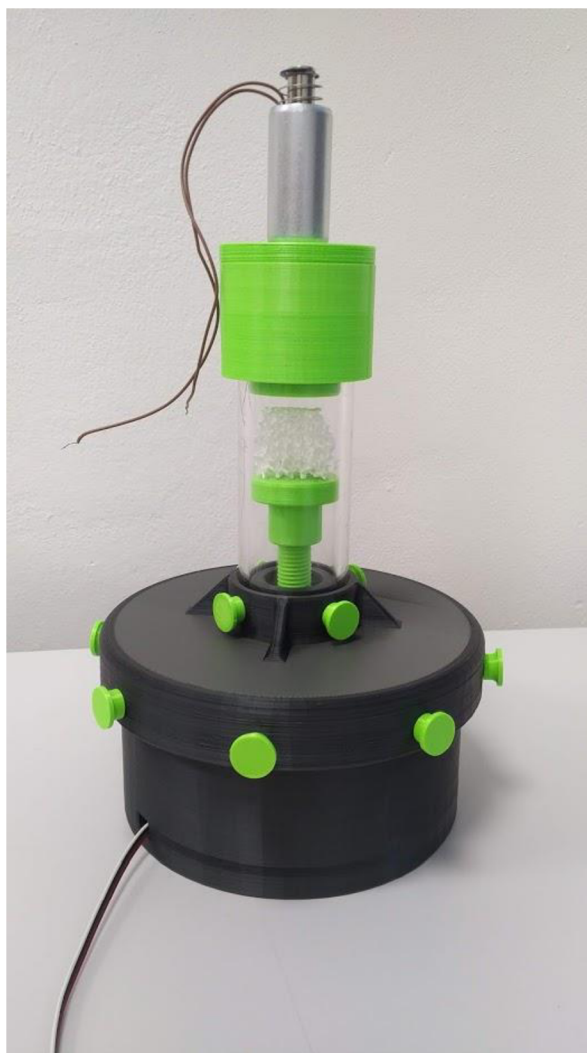
Obr. 16) Zatěžovací zařízení se vzorkem v zatěžovací komoře
