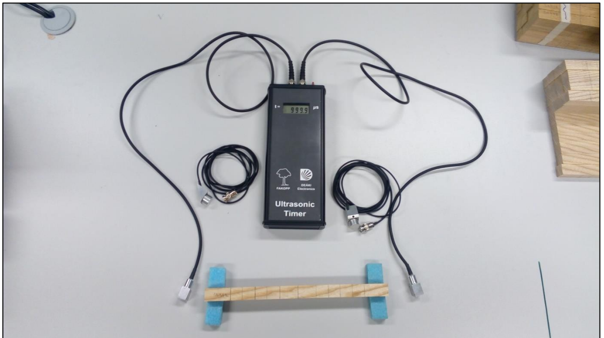
Obrázek 5: Fakopp UltraSonic Timer před měřením (David Novák)
