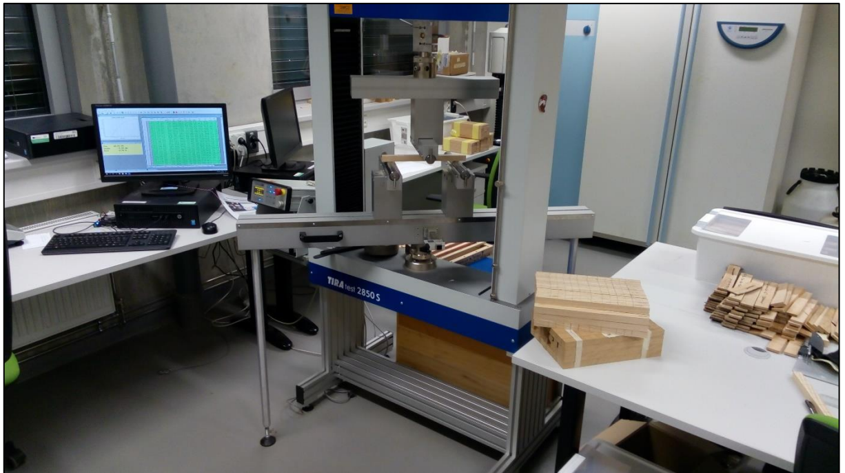
Obrázek 6: TIRA test 2850S při statické zkoušce ohybem (David Novák)
